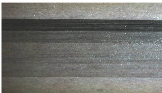
*Рис.2.4. Пример градиентной раскладки микропровода на барабане*
